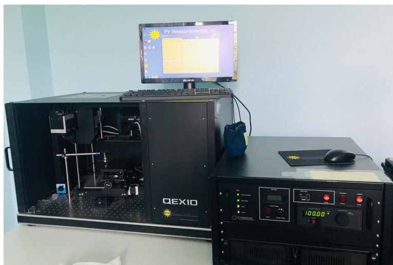
Сурет 16 - PV өлшемдері QEX10 кванттық тиімділікті өлшеу жүйесі
