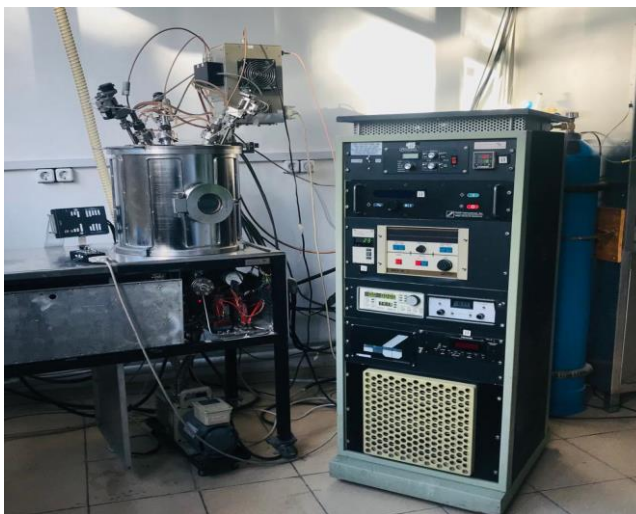
Сурет 12 - Магнетрон, TORR INTERNATIONAL. NEW WINDSOR -12553
